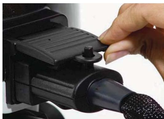
3) Rabattez ensuite le clapet de façon à ce qu'il s'insère dans la petite barre de sécurité.
